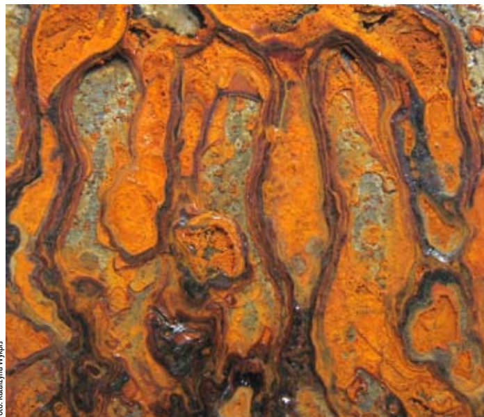
Foto: Katarzyna Wykpis Zdjęcia powierzchni podłoża stalowego poddanego działaniu mgły solnej
